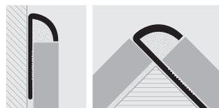
1.Scegliere "PROJOLLY OPEN" in funzione della spessore della piastrella. 2.Tagliare "PROJOLLY OPEN" alla lunghezza desiderata ed applicare l'adesivo sul supporto dove sarà posato il profilo. 3.Premere l'aletta di ancoraggio di "PROJOLLY OPEN" nell'adesivo. 4.Posare le piastrelle avendo cura di allinearle al profilo e di lasciare una fuga di circa 2 millimetri. 5.Stuccare accuratamente le fughe tra profilo e piastrella onde evitare il ristagno di eventuale acqua.
